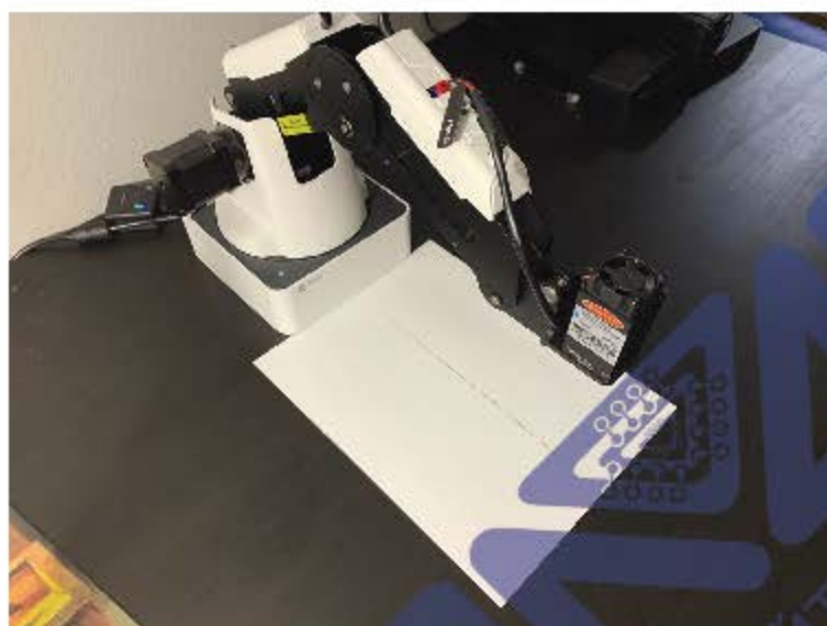
Рисунок III-5. Выжигание точек с различным интервалом работы лазера
