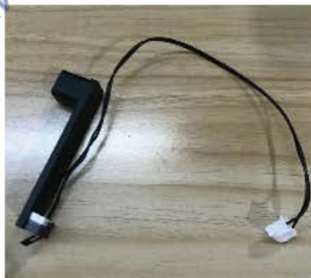
Рисунок I-13. Auto-levelling tool — инструмент автоматического выравнивания
