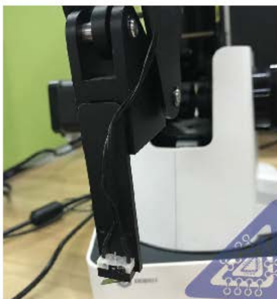
Рисунок I-14. Инструмент автоматического выравнивания в гнезде рабочего инструмента Dobot
