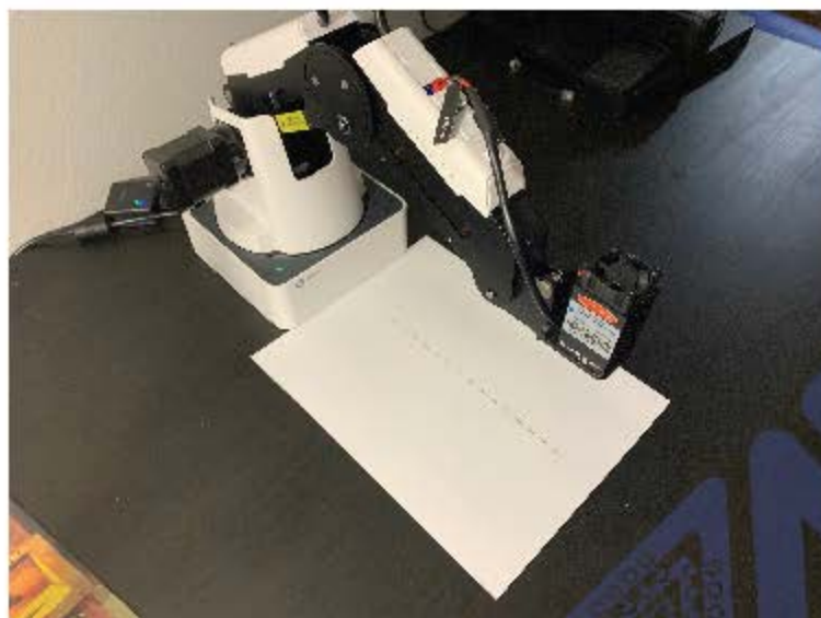
Рисунок IV-2. Выжигание ряда точек с интервалом в 1 мм
